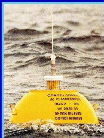
Le houlographe : destiné aux mesures de houle et de températures de l'eau de mer
