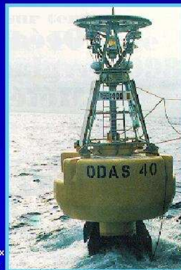
La bouée meteo-oceanographique : destinée aux mesures de pression, vent, température de l'air, de la surface de l'océan, humidité et houle
