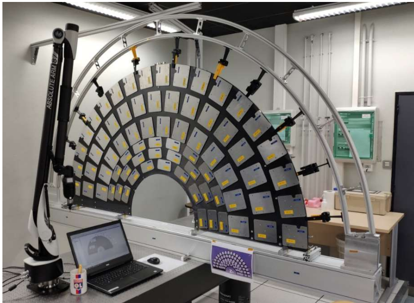
Dee sur le banc de mesure métrologique
